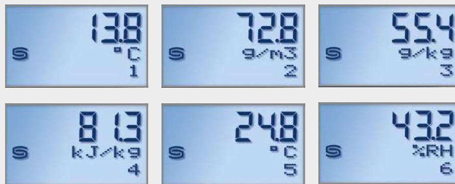
Visualizzazione display (statica) grandezze di uscita alternative
